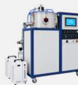
Vakuumli qoplash (sputtering)
